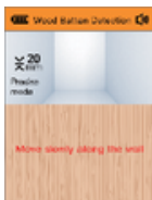
Detectie van houten latten. Beweeg langzaam langs de muur (Figuur 10)
