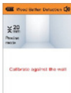
Detectie van houten lamellen. Kalibreren tegen de muur (Figuur 9)
