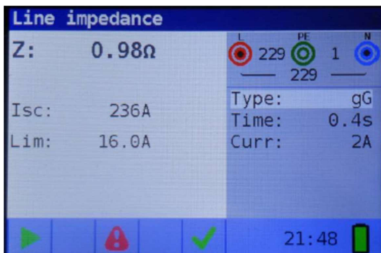
Figuur 5-35: Voorbeeld van lijn impedantie meting resultaten
